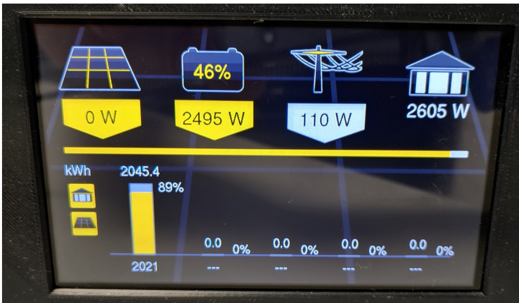
Roční histogram o spotřebě domácnosti v kWh s vyjádřením poměru energie dodané ze slunce:
