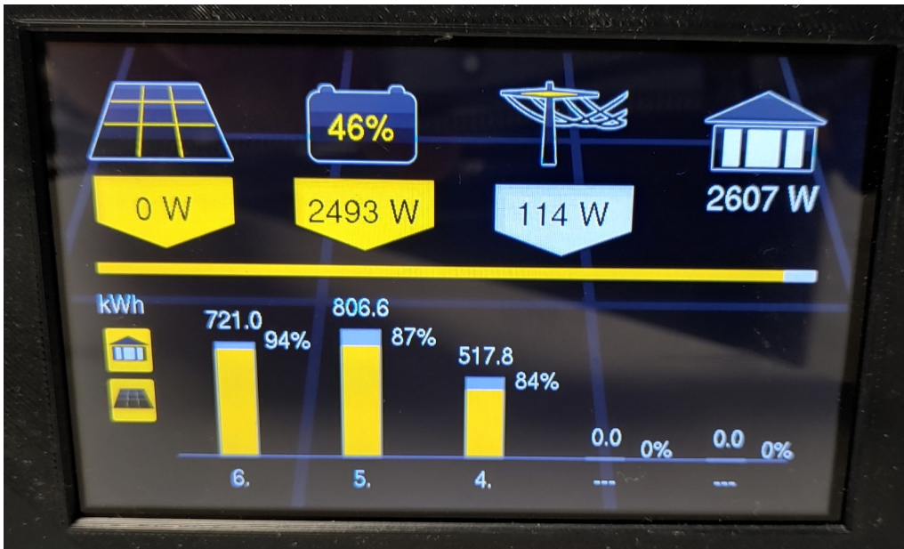
Roční histogram o spotřebě domácnosti v kWh s vyjádřením poměru energie dodané ze slunce:
