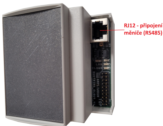
Obr. Konektor RJ45 pro připojení měniče GoodWe.
